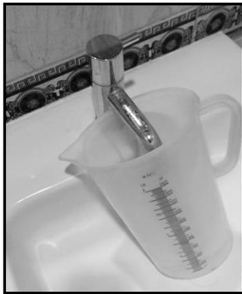
Gambar 2. Pengukuran Debit Air Keran Air
