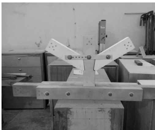
Gambar 15. Hubungan Balok Kunci cara 5 (Dokumentasi)
