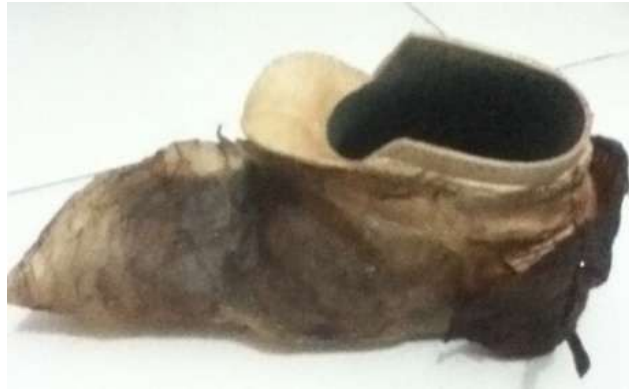
Gambar 11. Mencetak serat kombucha pada miniatatur sepatu berbahan karet (Foto. Aulia Kartika Putri. 2014)
