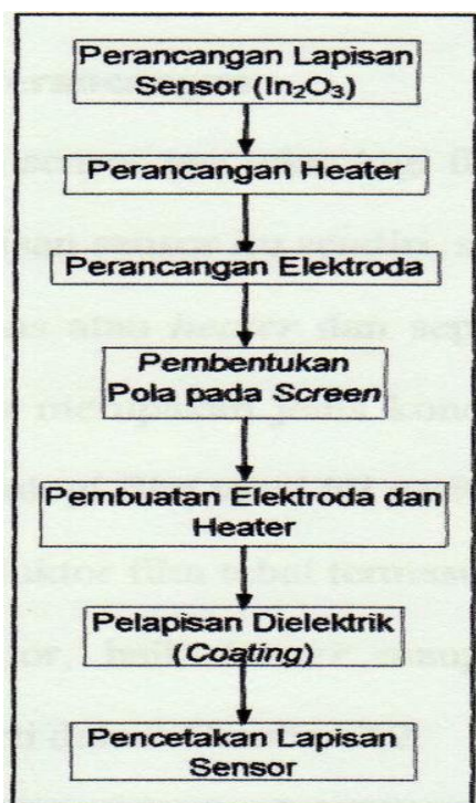
Gambar 3.1 Tahapan Proses Perancangan dan Fabrikasi Sensor Gas
