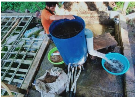
Gambar 1. Alat cuci lada yang digunakan pada proses pencucian lada putih
