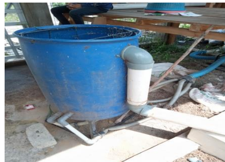
Gambar 1. Alat cuci lada yang digunakan pada proses pencucian lada putih
