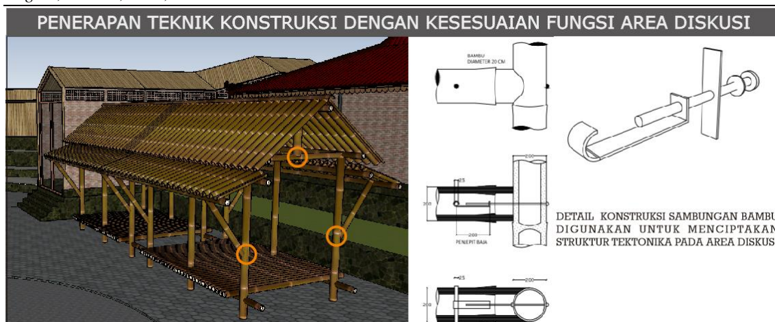
Gambar 10. Penerapan teknik konstruksi material dengan kesesuaian fungsi dari wadah bangunan yang dirancang di dalam kawasan industri rumah tangga kerajinan bambu. (Abraham Ardi Laksono, 2018)
