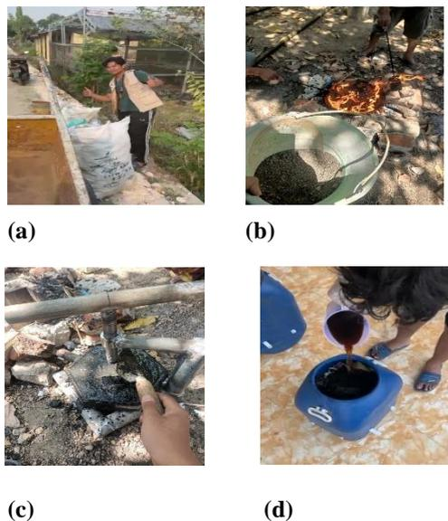
**Gambar 1.** Aktivitas Bank Sampah dan Produk Turunannya: (a) Pengambilan Sampah dari Rumah Warga; (b) Proses Pelelehan Plastik dan Penambahan Pasir Untuk Membuat Adonan *Paving Block*; (c) Pencetakan Adonan *Paving Block* Menggunakan Alat Press; (d) Pencampuran Komponen Organik dengan EM4 ke Dalam Komposter.
