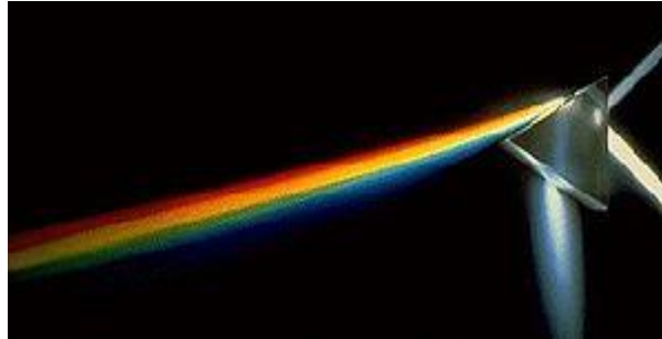
Gambar 1. Cahaya putih yang dipancarkan oleh sebuah prisma menjadi warna-warna dalam spektrum optic
