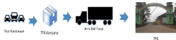
Gambar 4 Skema Metode Hauled Container Sistem
