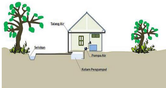
Gambar 2. Gambar kolam pengumpulan air hujan di bawah permukaan tanah
