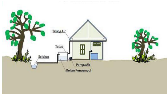
Gambar 1. Gambar kolam pengumpulan air hujan di atas permukaan tanah
