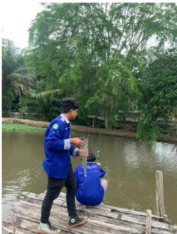
Gambar 7. Peletakan alat *sediment trap* di kolam dua
