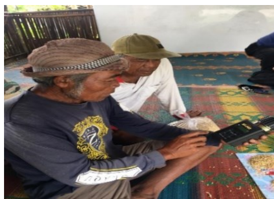
Gambar 4. Pelatihan penggunaan grain moisture tester untuk menentukan kadar air gabah kering panen
