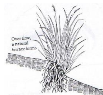
Seiring waktu rumpun akar wangi (kiri) membentuk teras alami (kanan)
