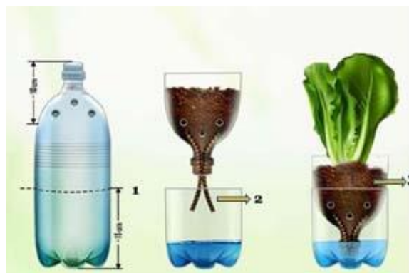
Gambar 1. Persiapan media tanam: (a). batas potongan botol, (b) sumbu terbuat dari kain flanel atau sumbu kompor, (c) media penyangga berupa kerikil, sabut kelapa, atau sekam padi
