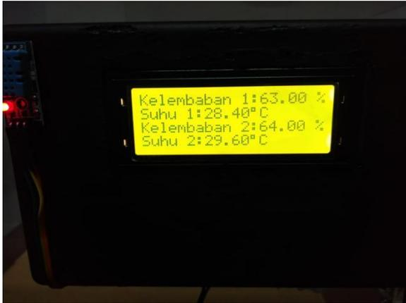
**Gambar 4.** Hasil Pembacaan Sensor DHT11 Setelah Kipas Menyala Pada Prototipe *Smart Insulation*
