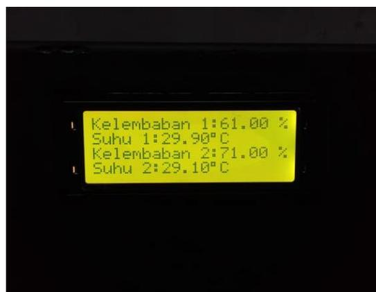
**Gambar 3.** Hasil Pembacaan Sensor DHT11 Sebelum Kipas Menyala Pada Prototipe *Smart Insulation*
