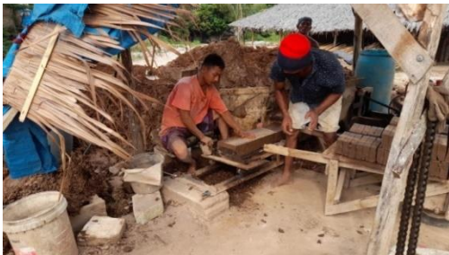
Gambar 2. Pencetakan dan Pemindahan Batu Bata
