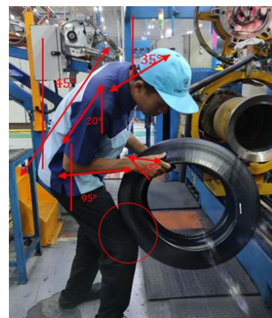
Gambar 5. Kondisi saat aktivitas inspection Hasil dari gambar diatas kemudian dilakukan perhitungan skor RULA( Rapid Upper Limb
