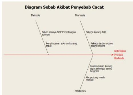
Gambar 8. Fishbone Diagram Ketebalan Produk Berbeda
