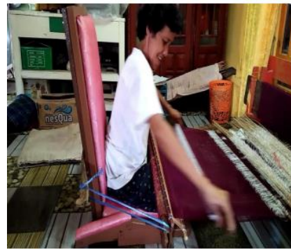
Gambar 4. Penerapan Alat Bantu Pada Pengrajin Songket Palembang
