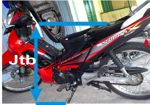
Gambar 7. Jarak lubang tangki bensin dengan lantai
