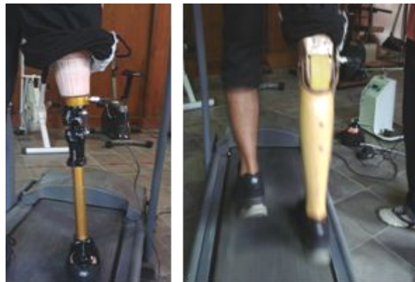
Gambar 2. Pengujian getaran mekanik pada ke dua model prosthetic
