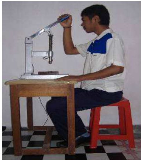
Gambar 3. Uji coba pengoperasional alat pemotong bulu
