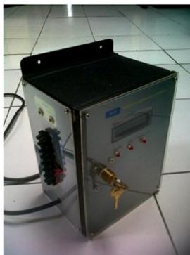
**Gambar 3.** Prototipe Alat Pengatur Suhu dan Kelembaban
