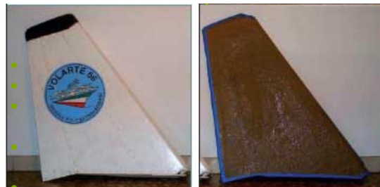
Gambar 8. Prototipe Ultralight Plane dari Serat Hemp
