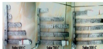
Gambar 5. Spesimen Uji Fluiditas
