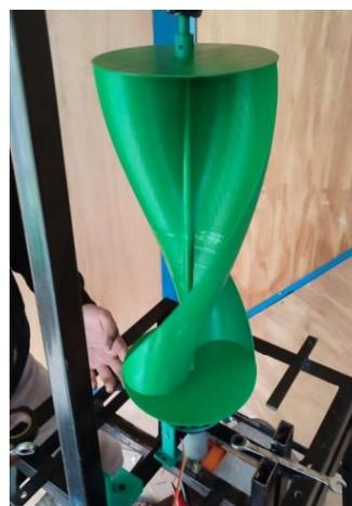
Gambar 17. Turbin Angin *Savonius* Heliks
