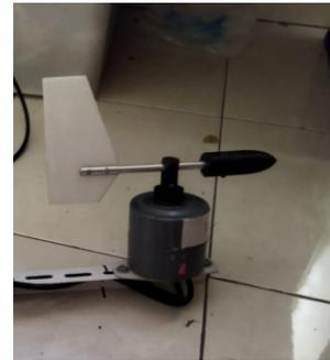
Gambar 8. Alat Pengukur Arah Angin
