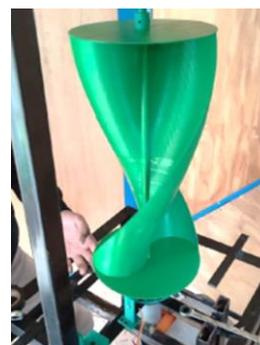
Gambar 16. Turbin *Savonius* Tipe Heliks
