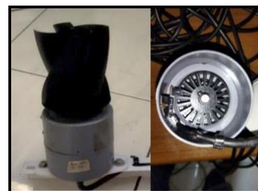
Gambar 6. Alat Ukur Kecepatan Angin
