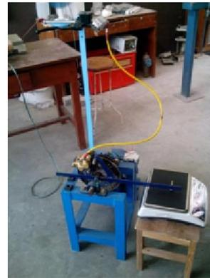
Gambar 2. Mesin *Prony Brake*
