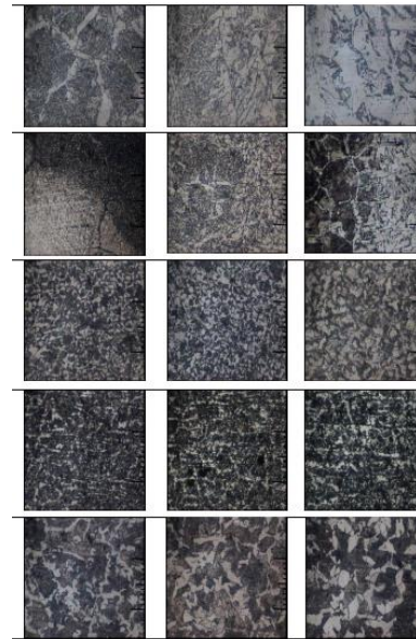
Gambar 3. Foto Struktur Mikro Spesimen Baja S45C Hasil Pengelasan GMAW dengan Perbesaran 200x
