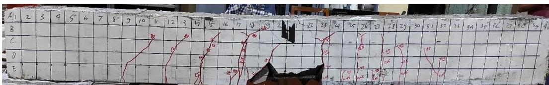
Gambar 2 Gambar Pola Retak Spesimen B 16
