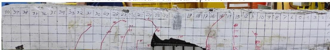
Gambar 3 Gambar Pola Retak Spesimen B 19
