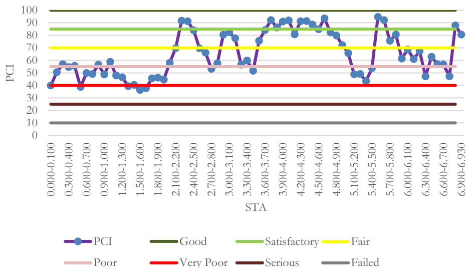
Gambar 3. Skala Tingkat Kerusakan Fungsional pada Ruas Jalan Lingkar Demak Jalur Kiri
