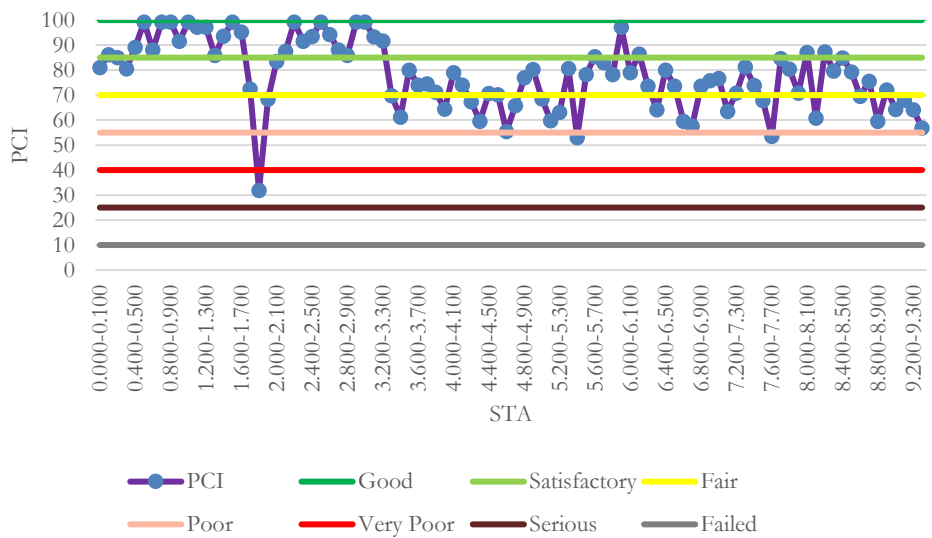
Gambar 5. Skala Tingkat Kerusakan Fungsional pada Ruas Jalan Losari – Pejagan Jalur Kiri
