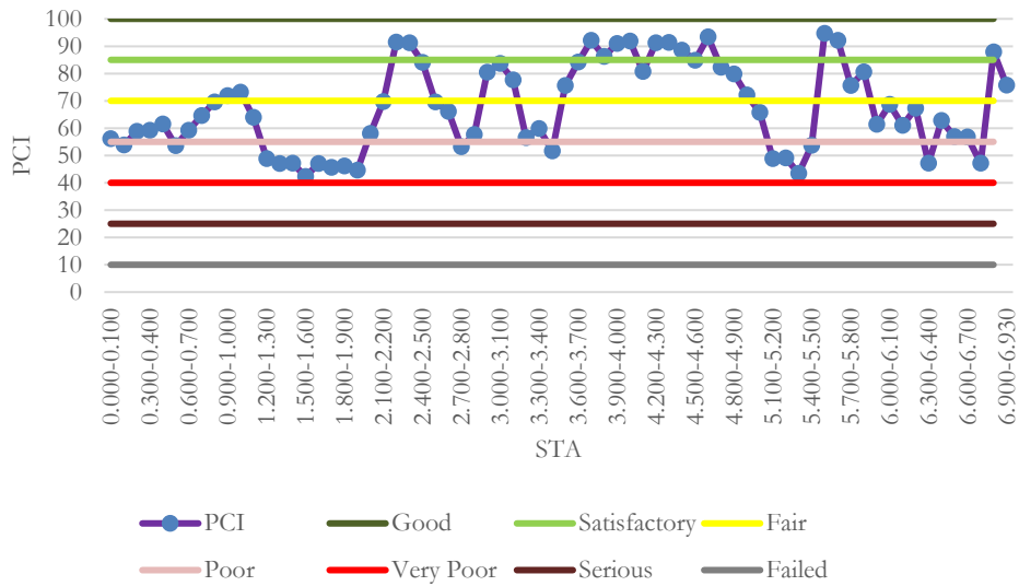
Gambar 4. Skala Tingkat Kerusakan Fungsional pada Ruas Jalan Lingkar Demak Jalur Kanan
