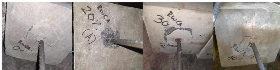
Gambar 10. Kehancuran beton pengujian kuat lekat
