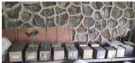
Gambar 1. benda uji pengujian kuat lekat
