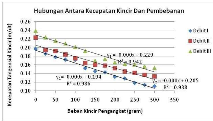
Gambar 3.3 Hubungan Antara Jumlah Putaran Kincir Dengan Kecepatan Aliran Dan Beban Yang Diberikan Pada Kincir Pengangkat
