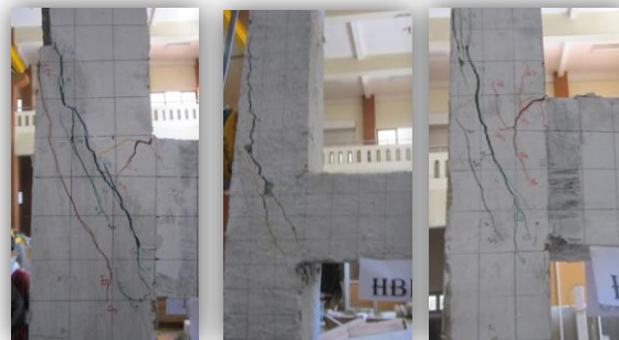
Gambar 7. Pola retak HBK beton normal
