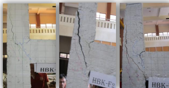
Gambar 8. Pola retak HBK beton fly ash
