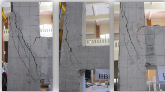
Gambar 7. Pola retak HBK beton normal
