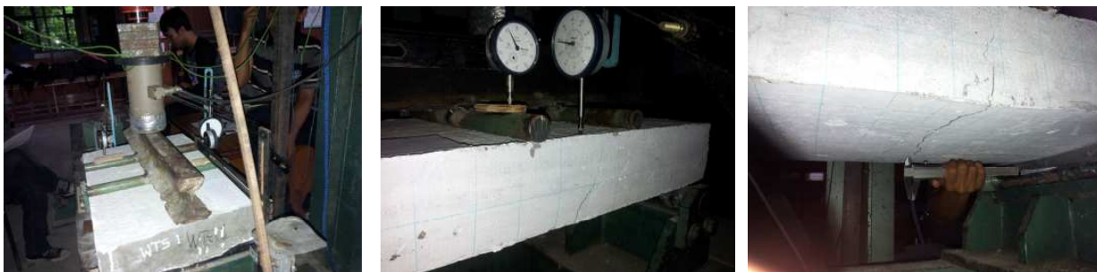
Gambar 9. Pengujian plat dan crack yang terjadi
