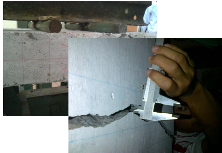
Gambar 9. Hasil retak plat beton plat beton tulangan yang telah dilakukan
