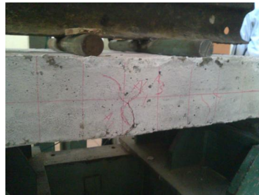
Gambar 7. Hasil retak plat beton bertulang baja pada saat diberi beban
