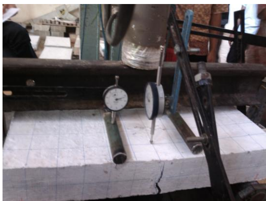
Gambar 8. Hasil retak plat beton bertulang bambu petung polos saat mencapai beban
