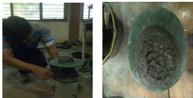
Gambar 3. Pengujian slump flow
