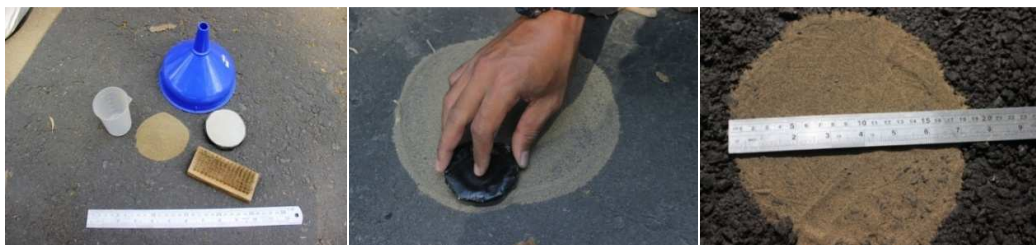
Gambar 2. Pengujian Kedalaman Tekstur dengan Sand Patch
