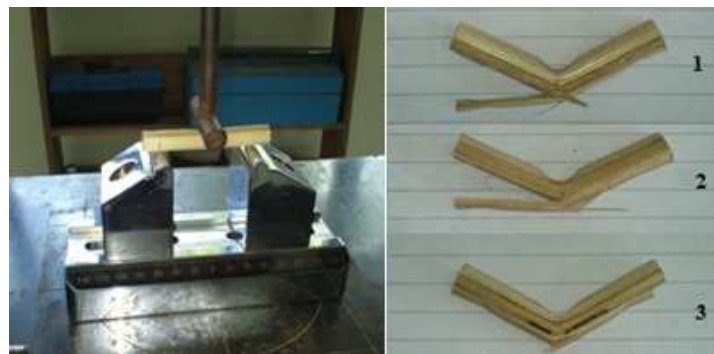
Gambar 4. Hasil Pengujian Kuat Lentur Pasak
