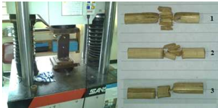
Gambar 6. Hasil Pengujian Kuat Geser Pasak
