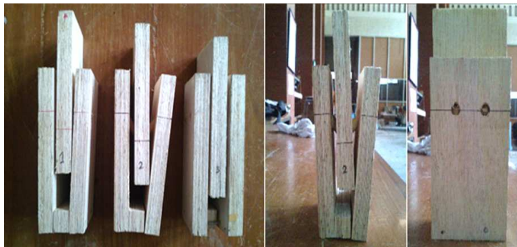
Gambar 7. Hasil Pengujian Sambungan Tekan
