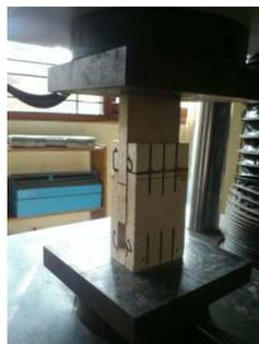
Gambar 4. Kegagalan Struktur pada Sambungan Tekan
