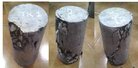
Gambar 3. Hasil uji kuat tekan umur 28 hari
