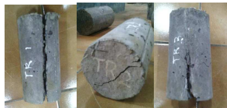
Gambar 4. Hasil uji kuat tekan umur 28 hari
