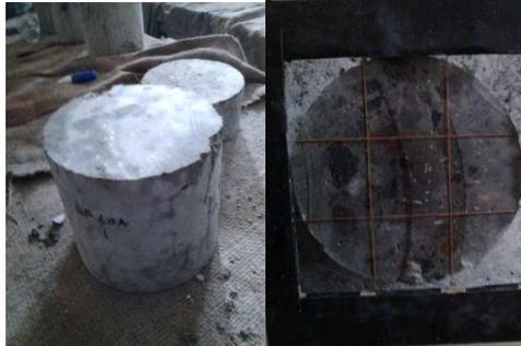
Gambar 3. Distribusi Serat Setelah Beton Dipotong
