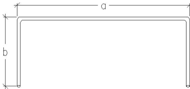
Gambar 1. Sketsa Penulangan Pile Cap Pola 1
