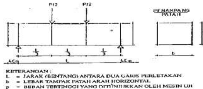
Gambar 1. Perletakan dan Pembebanan Balok Uji
