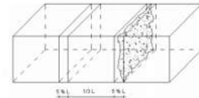
Gambar 5. Patah pada 1/3 bentang tengah pada < 5% bentang
