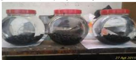
Gambar 8. Hasil pengujian kelekatan aspal pada agregat
