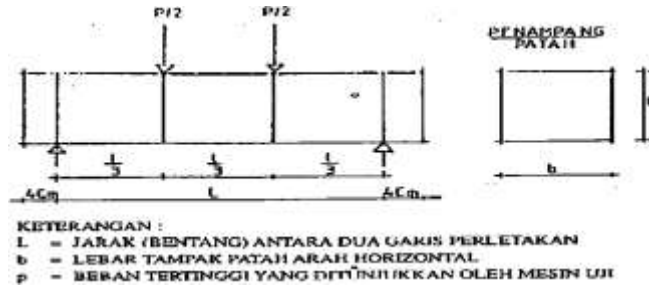
Gambar 1. Perletakan dan Pembebanan Balok Uji (Sumber: SNI 03-4431-1997)
