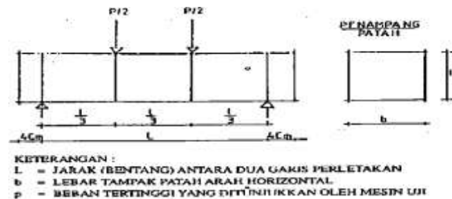
Gambar 1. Perletakan dan Pembebanan Balok Uji
